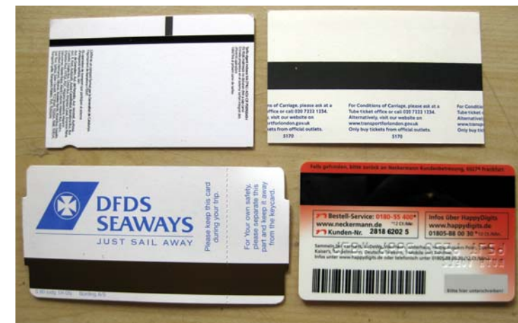
Oben links: U-Bahn-Fahrkarte von Barcelona. Nur langer, schmaler, schwarzer Bereich ist mit Magnetmaterial beschichtet, kurzer senkrechter Strich ist aufgedruckte Kennung, keine Eckenrundung Oben rechts: Londoner U-Bahn, dito keine Eckenrundung Unten links: Fähre Amsterdam - Newcastle Unten rechts: Neckermann-Versand mit zusätzlichem Prägedruck und Barcode
