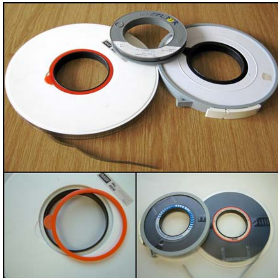
Bügel um Spule zum (Staub-) Schutz, rot = entfernenbarer Schreibschutz-Ring
